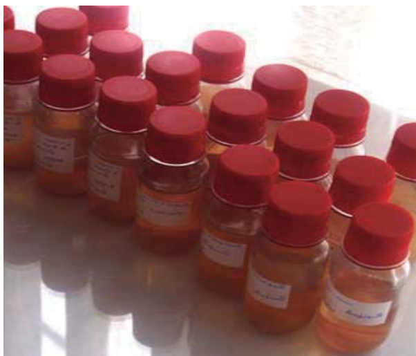
Primera prueba de estabilidad de la Vitamina C
